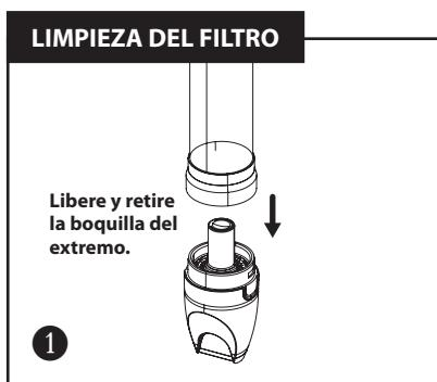
1. Retire la válvula y el filtro de la boquilla del extremo.
